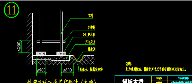
外部立杆支承基底作法(木板)
